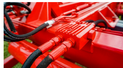
Válvula limitadora de presión hidráulica.
